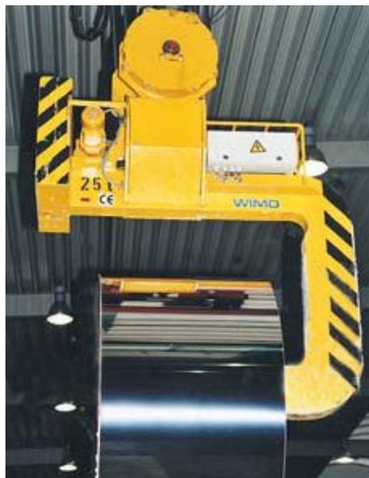
**Крюки для перемещения бобин и рулонов с возможностью вращения груза, оснащенные электродвигателем.**
