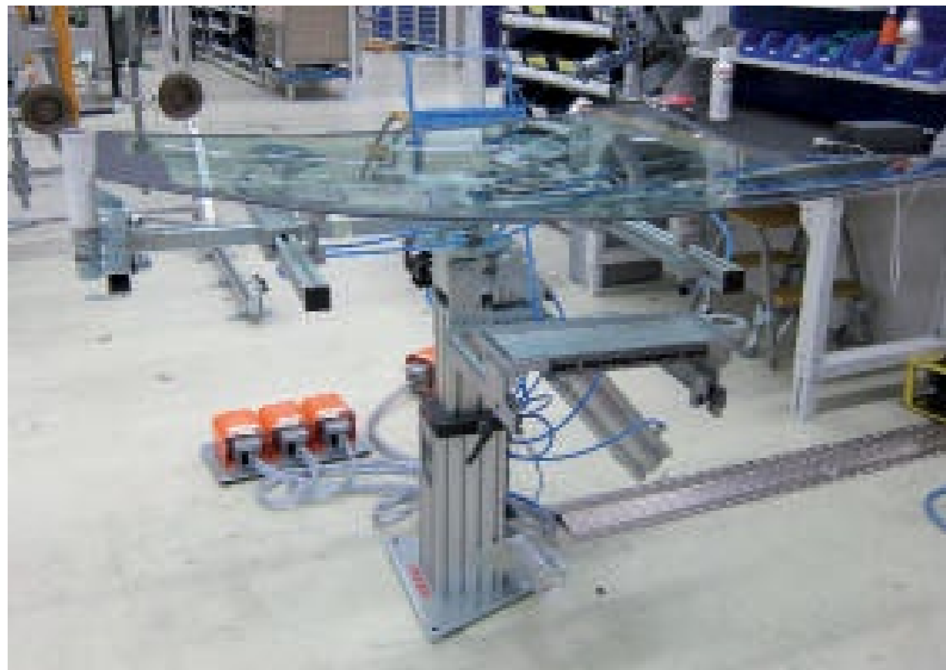
VacuStand VS-I с пневмоприводом поворота рабочего стола для установки боковых и задних стекол на линии сборки автомобилей
